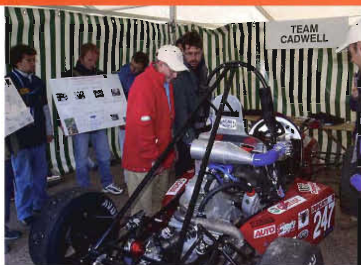
La F2004-V2ss durante la prova di design. Il sistema di aspirazione era stato realizzato con tubi di gomma rinforzati con anelli di acciaio per resistere alle depressioni prodotte dal motore, il plenum era stato realizzato con lamiera di alluminio piegata e saldata.
