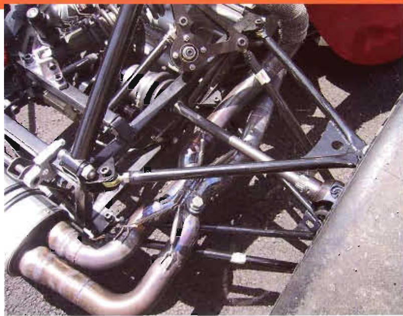
Il particolare sistema di compensazione della F2004-V2ss "2-1-2".
